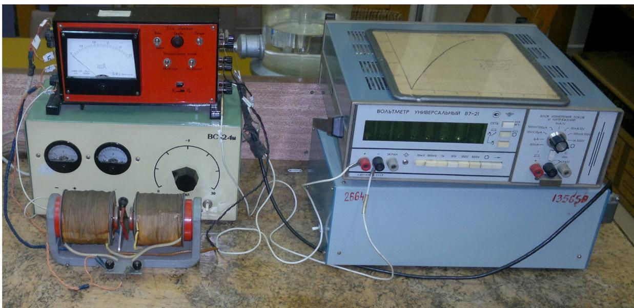
Полупроводниковый образец помещается между полюсами электромагнита 1. Ток в электромагните создается с помощью выпрямителя ВС-24М. Для изменения направления тока в обмотке магнита имеется специальный переключатель, расположенный на панели управления 2.
