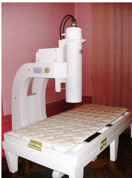
Рис. 0.9. 12-канальная СКВИД-система для измерения магнито-кардиограммы сердца человека.
