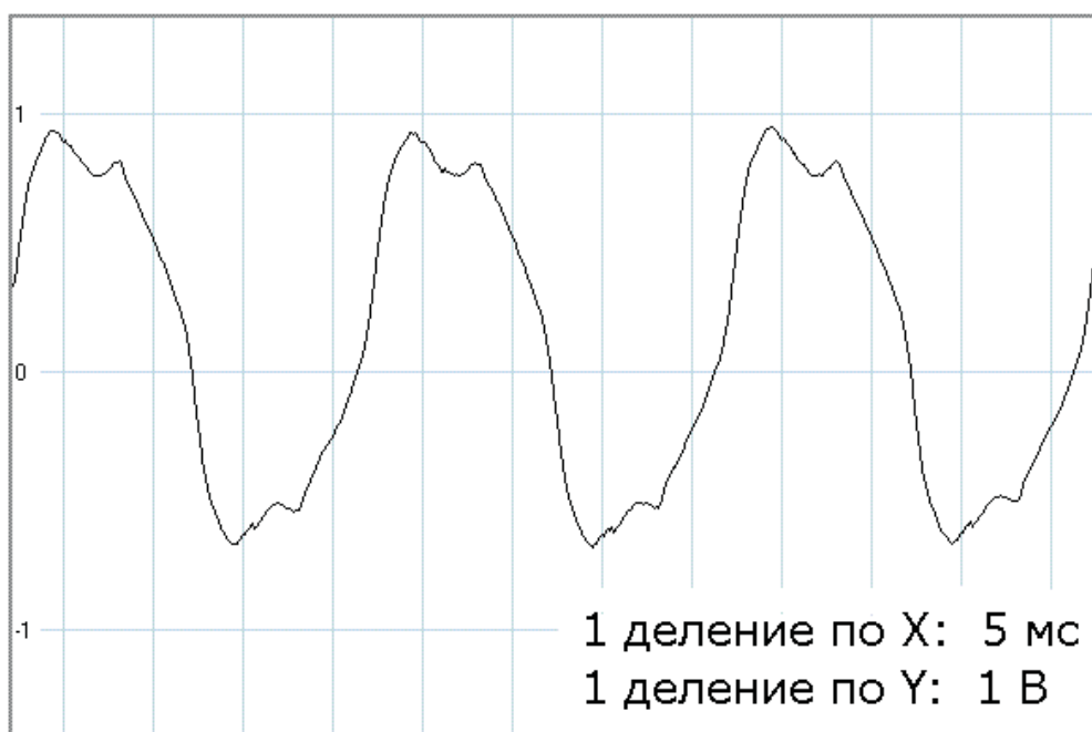
Рис. 1.15. Осциллограмму сигнала от внешнего магнитного поля в лаборатории.
