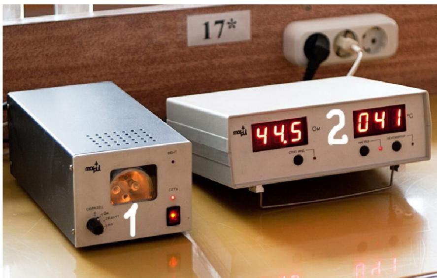
В сборном корпусе 1 объекта исследования установлены: электропечь с размещенными внутри образцами, температурный датчик (термометр сопротивления), вентилятор для охлаждения образцов и источники питания электропечи и вентилятора. Электропечь служит для нагрева образцов до максимальной температуры 120 °C в течение 15 – 20 минут. Вентилятор служит для ускорения охлаждения образцов. На передней панели корпуса 2 размещены органы управления и индикации.
