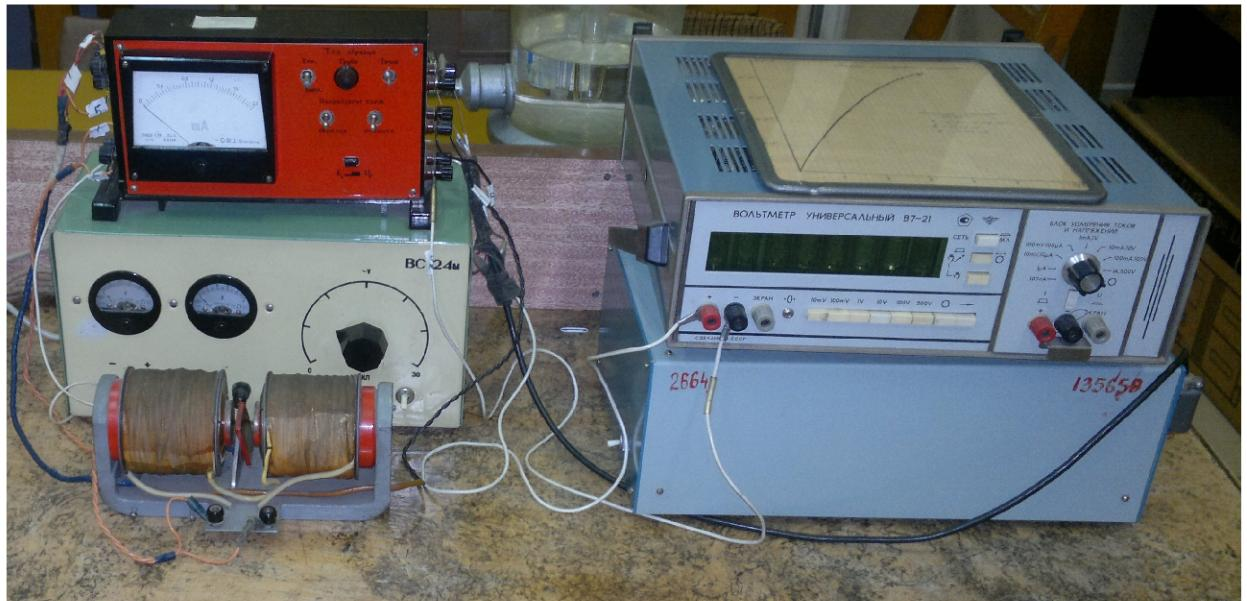
Полупроводниковый образец помещается между полюсами электромагнита 1. Ток в электромагните создается с помощью выпрямителя ВС-24М. Для изменения направления тока в обмотке магнита имеется специальный переключатель, расположенный на панели управления 2.
