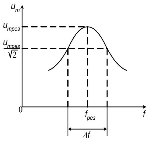
Для практического использования колебательных контуров, например, в радиотехнике важной характеристикой контура является ширина резонансной кривой  $\Delta f$ . Она определяется скоростью затухания колебаний в контуре, которая численно характеризуется величиной добротности  $Q$ . Для последовательного контура добротность может быть рассчитана по формуле:
