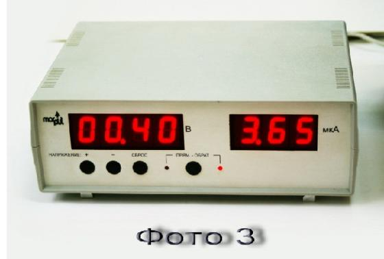
На передней панели измерительного устройства (6) находятся два цифровых светодиодных табло для вывода результатов измерения тока (мкА) и напряжения (В), кнопки ПРЯМАЯ–ОБРАТНАЯ для включения прямого и обратного режимов измерения, кнопки СБРОС, «+» и «-» для регулировки напряжения на фотоэлементе и его сброса на ноль (фото 3).
