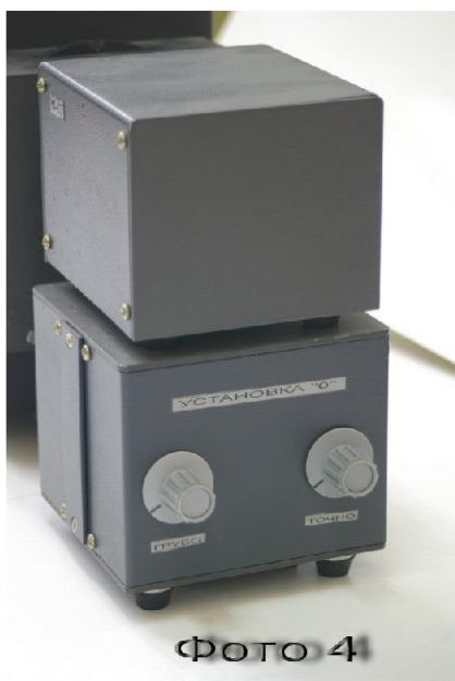
Блок с фотоэлементом (4) закреплен в гнезде на верхней части корпуса усилителя тока (5). На боковой части корпуса усилителя тока фотоэлемента расположены две регулировочные ручки УСТАНОВКА
