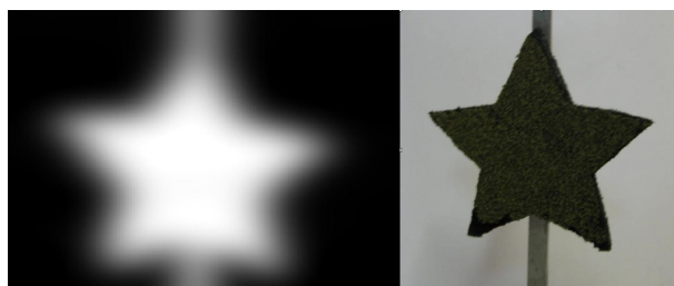
Рис. 7. Терагерцовое изображение тестового объекта «звезда» и его изображение в оптическом диапазоне.
